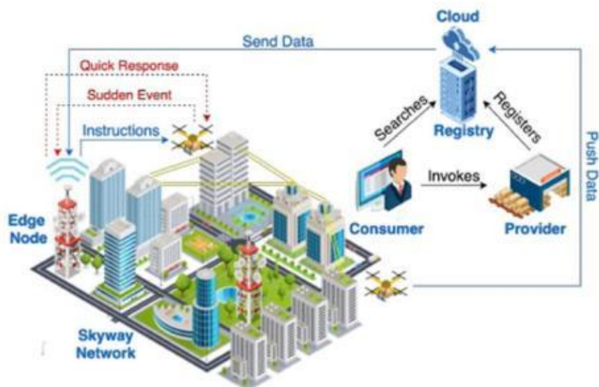
Рисунок 8 – Типовая архитектура сервиса перевозки БВС в сети Skyway
